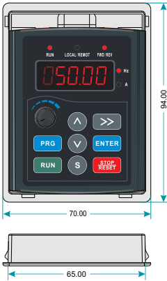
图2-5 键盘安装结构尺寸图
